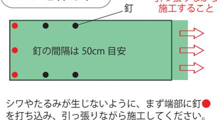
シワやたるみが生じないように、まず端部に釘を打ち込み、引っ張りながら施工してください。
