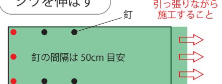
シワやたるみが生じないように、まず端部に釘●を打ち込み、引っ張りながら施工してください。
