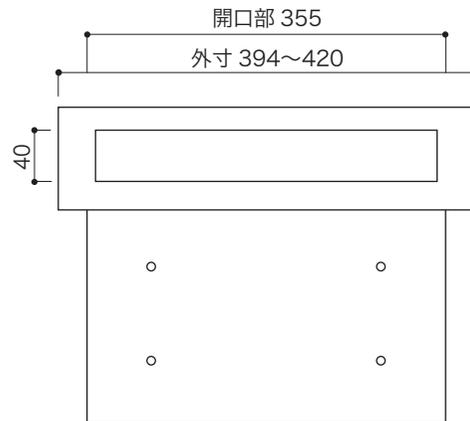
〈2Bサイズ切欠代120mmタイプ側面図〉
