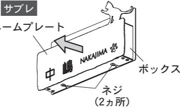
ボックス下部の2カ所のネジをゆるめ、ネームプレートを取り外します。
