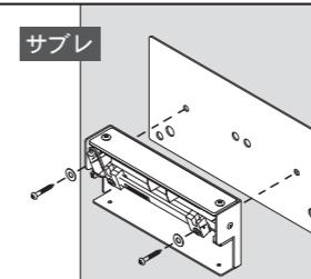
壁面の穴にバックプレートとボックスの取付穴を合わせます。ボックスと木ネジの間にワッシャーを挟み、木ネジで取り付けます。
