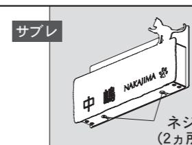
1 で取り外しておいたネジでネームプレートとボックスを再度、締め直し固定します。
