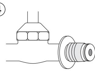
④立水栓などの給水管の雌ネジに蛇口をねじ込みます。
