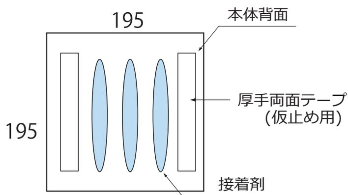
位置決めをして本体背面と設置面双方に接着剤を塗布してしっかり圧着固定してください。
