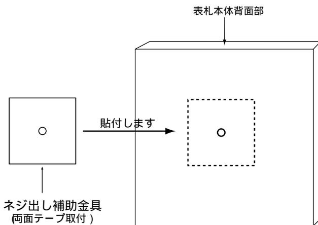
ネジ出し補助金具を先に両面テープで取り付けます。取り付ける位置は任意ですが中心部にセットするのがバランスがとりやすいです。
