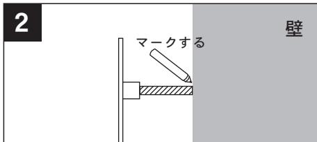
壁面の汚れや付着物を落とし、取付場所に表札が傾かないよう水平にあてがいます。ボルト位置をペン等で壁面にマークします。
