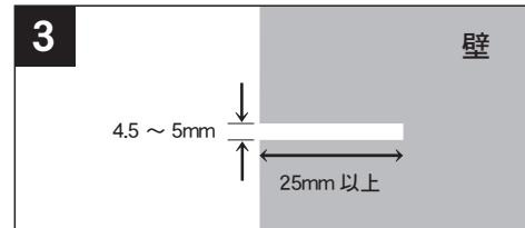
マーク位置にドリルで垂直に穴を開けます。表札を壁から浮かしたい距離になるよう調整しながら穴を開けてください。
