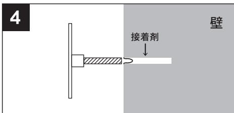
壁面の穴に接着剤を注入し、表札のボルトを差し込みます。
