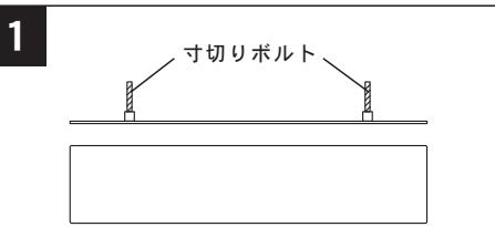
付属の寸切りボルトを表札裏面のネジ穴にねじ込んで取り付けます。ゆるみがないようご注意ください。
