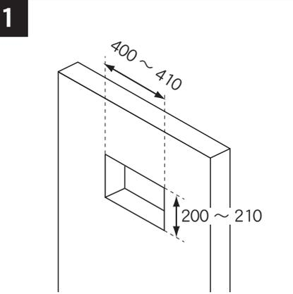
壁面にポスト本体外形寸法 (W390×H190) より 10～20mm 大きめの穴を開けます。ブロック塀に取り付ける場合は、ブロック積み上げ時にポストを取り付けます。
