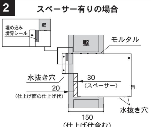
ポスト本体を壁に入れ水平出しを行い、ポストの周囲をモルタルやシーリング材で仕上げ、ポストを固定します。
