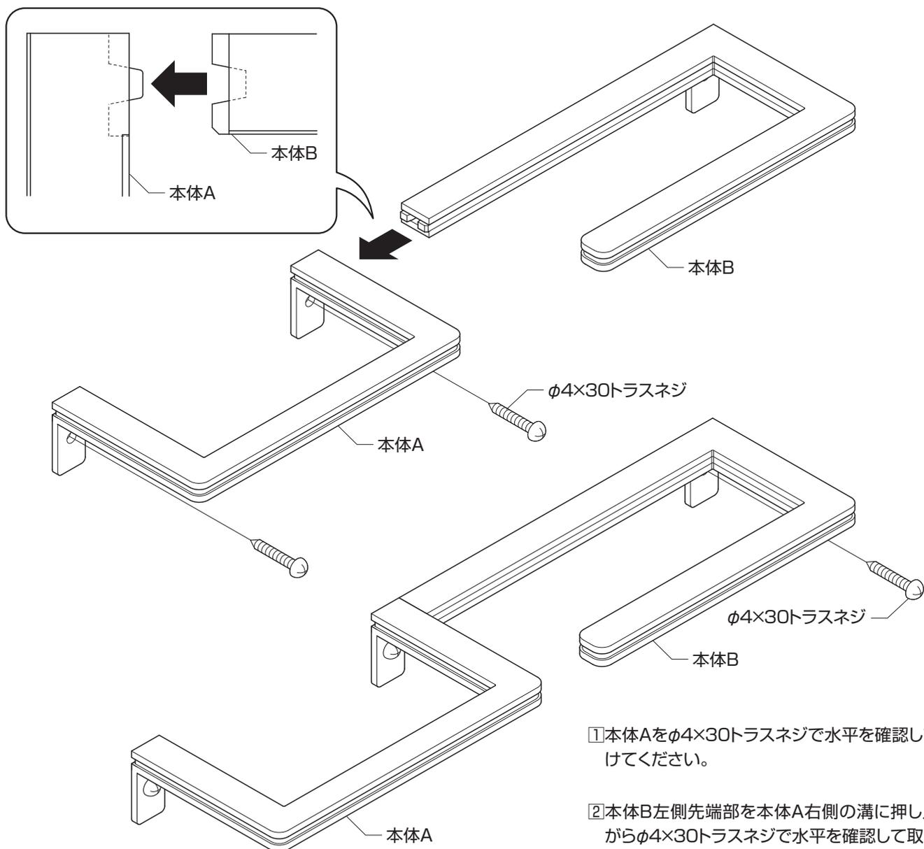
① 本体Aをφ4×30トラスネジで水平を確認して取付けてください。
