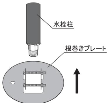
②GLから約10cm下の位置にボルトナットを締め付けて水栓柱に取付けます。
