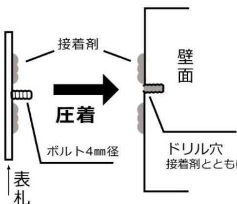
表札裏面に溶接されているボルトを取り付け面にあてて鉛筆等で印を付け位置決めをします。M4よりやや大きめのドリルで設置面に穴を開け、中のほこりをしっかり取り除いて下さい。ネジ出し金具にも接着剤を塗布し、そのまま図の様に差し入れ固定します。接着剤が硬化し動かなくなれば設置完了です。
