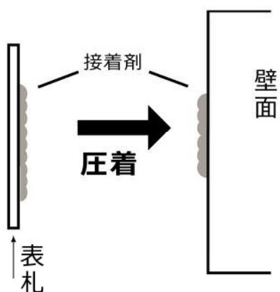
比較的平坦な壁面に取り付ける場合左図の様に接着剤で表札を直接壁面に圧着します。接着剤が硬化し動かなくなれば設置完了です。
