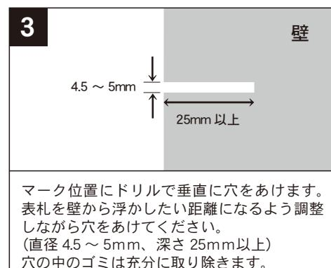
マーク位置にドリルで垂直に穴を開けます。表札を壁から浮かしたい距離になるよう調整しながら穴を開けてください。
