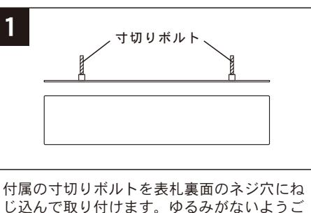
付属の寸切りボルトを表札裏面のネジ穴にねじ込んで取り付けます。ゆるみがないようご注意ください。
