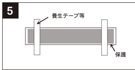
表札の表面を保護してから、養生テープ等で固定します。接着剤が完全に硬化したら、テープを剥がします。
