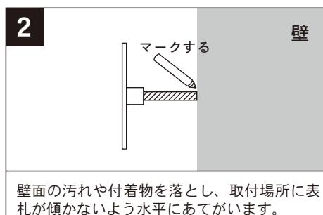
壁面の汚れや付着物を落とし、取付場所に表札が傾かないよう水平にあてがいます。ボルト位置をペン等で壁面にマークします。
