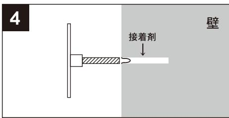
壁面の穴に接着剤を注入し、表札のボルトを差し込みます。
