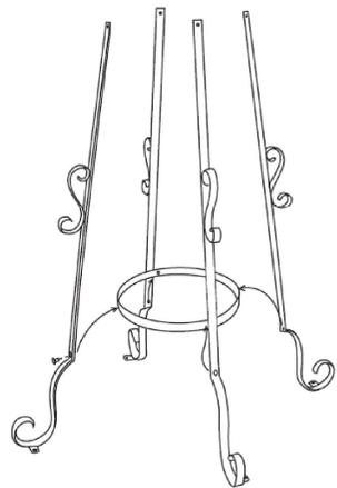
2 冠の外側に脚を当てて、付属のボルトを六角レンチで仮締めします。
