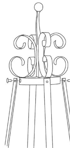
3 冠と脚を仮締めした後、脚とリングを固定するボルトを仮締めします。
