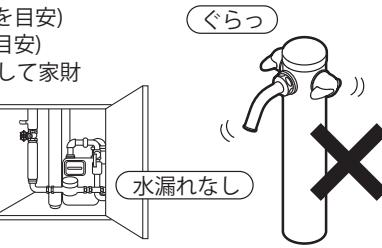
漏水を確認した場合は、配管中の元栓を閉めてください。
