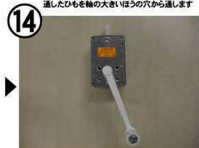
ハンドルを回転させ ひものたるみがケースに収まるまで巻き込みます。
