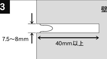
印をつけた位置にドリルで穴を開けます。穴の中のゴミは充分に取り除きます。壁面の穴に接着剤を注入し、アンカープラグを差し込みます。(壁面の穴：直径 7.5～8mm、深さ 40mm 以上)
