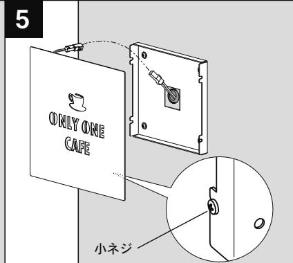
LED付の場合は、PF管から出ているコネクタと本体側のコネクタをカチッと音がするまで接続します。商品本体を取り付け、ゆるめておいた小ネジをプラスドライバーで締め込み固定します。
