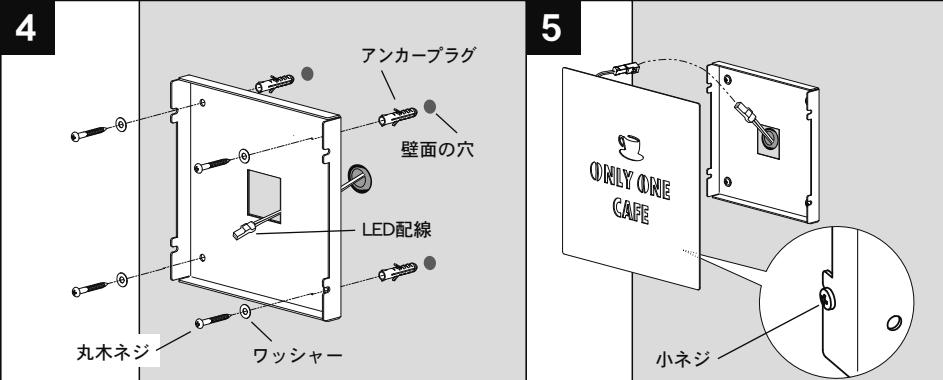
壁面の穴に付属のアンカープラグを奥まで差し込みます。壁面に取付板をあてがい、取付板の穴と壁面の穴を合わせて丸木ネジでねじ込み、取り付けます。LED付の場合は、PF管から出ているコネクタを取付板の配線用穴に通しておきます。
