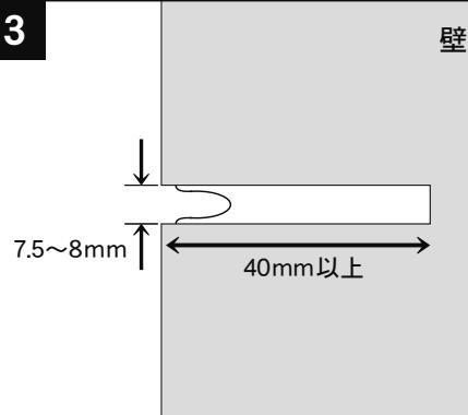
印をつけた位置にドリルで穴を開けます。穴の中のゴミは充分に取り除きます。壁面の穴に接着剤を注入し、アンカープラグを差し込みます。（壁面の穴：直径 7.5 ~ 8mm、深さ 40mm 以上）
