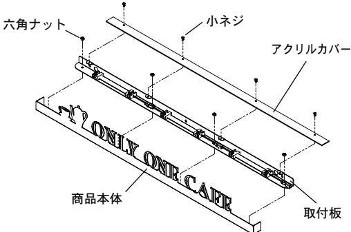
商品に取り付けてあるアクリルカバーと取付板の小ネジをゆるめて取り外します。取付板内側にある六角ナットを緩め、商品本体と取付板を分解します。
