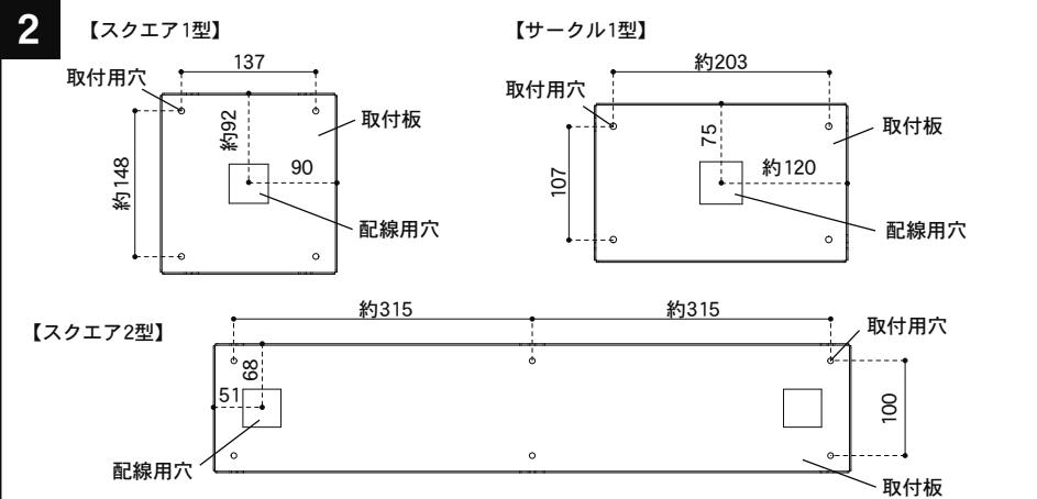
壁面の汚れや付着物を落とします。取付場所に取付板が傾かないよう水平にあてがい、本体取付用穴の印をつけます。（LED付の場合は、配線用穴の印をつけます。）
