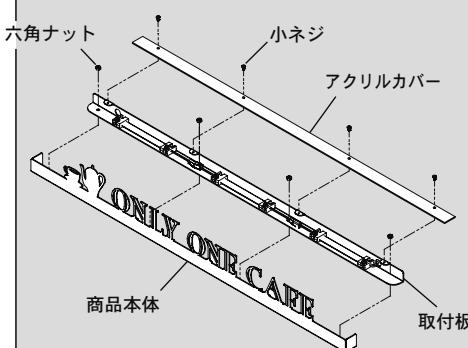
商品本体を取付板に取り付け、取り外しておいた六角ナットをナットドライバーで締め込み固定します。最後にアクリルカバーを取り付け、プラスドライバーで小ネジを締め込み固定します。
