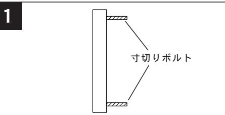
付属の寸切りボルトを表札裏面のネジ穴にねじ込んで取り付けます。ゆるみがないようご注意ください。
