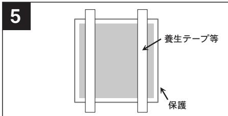
表札の表面を保護してから、養生テープ等で固定します。接着剤が完全に硬化したら、テープを剥がします。
