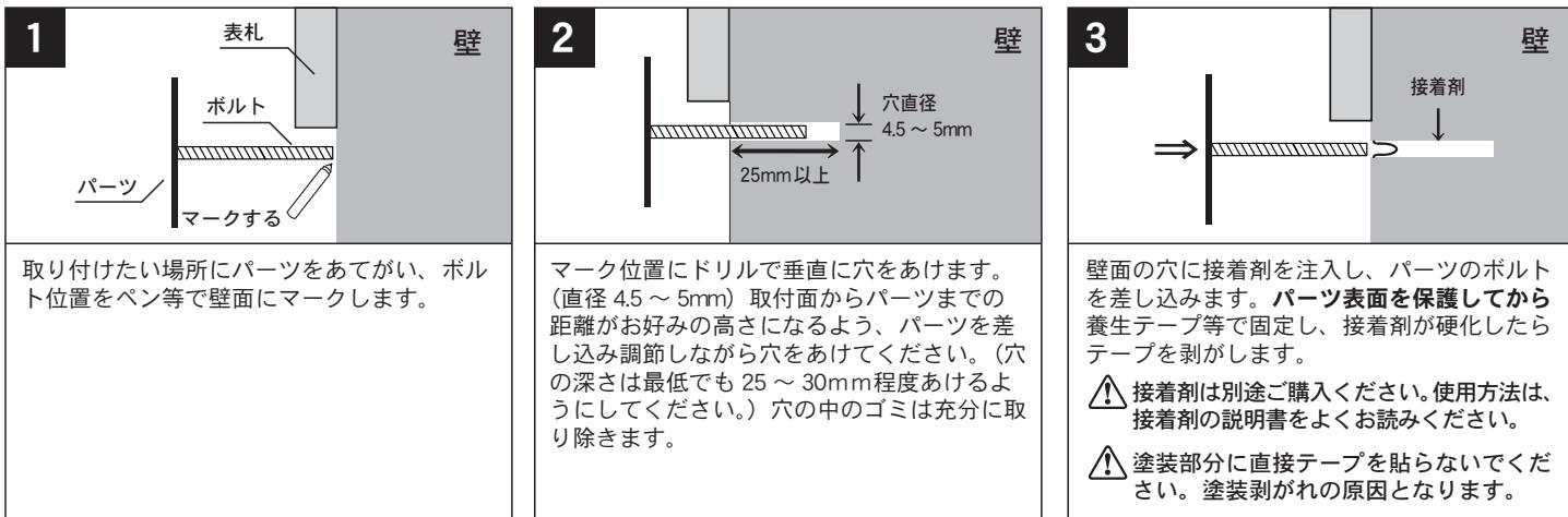
取り付けたい場所にパーツをあてがい、ボルト位置をペン等で壁面にマークします。
