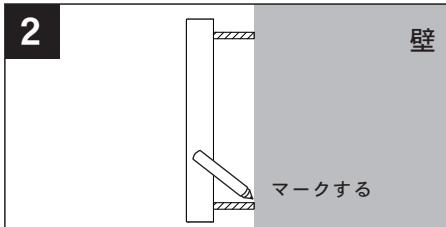
壁面の汚れや付着物を落とし、取付場所に表札が傾かないよう水平にあてがいます。
