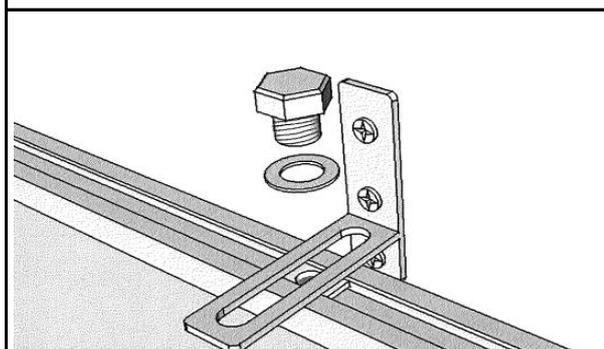
⑤T型金具をボルトとナットで固定します。ナットはレールのサイドから平たい面を上、に、滑り込ませるように入れ六角レンチ等でしっかり固定してください。
