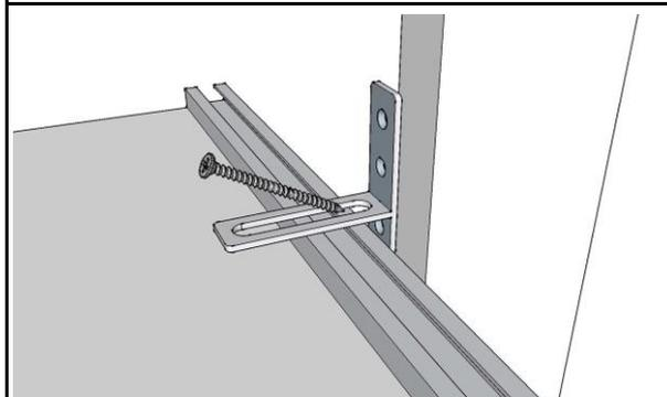
③仮置きのスライドレールを外し、下側も65mm ビスで固定し、上2か所もしっかりと固定。
