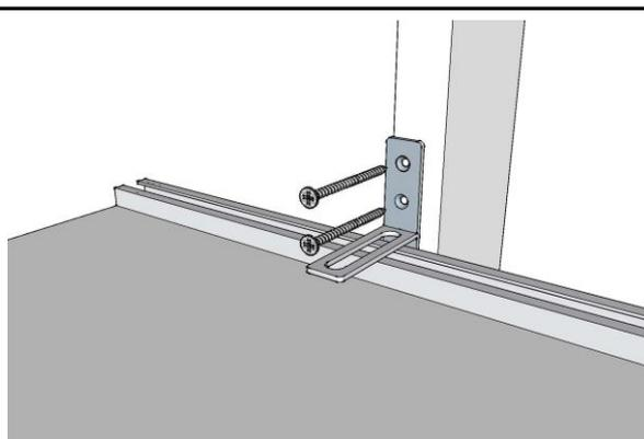
②壁中の間柱を下地探して見つけ、付属の 65mmビスでT字金具の上2か所を電動工具等で間柱に仮止める。(下地探しはホームセンター等で別途ご購入ください)
