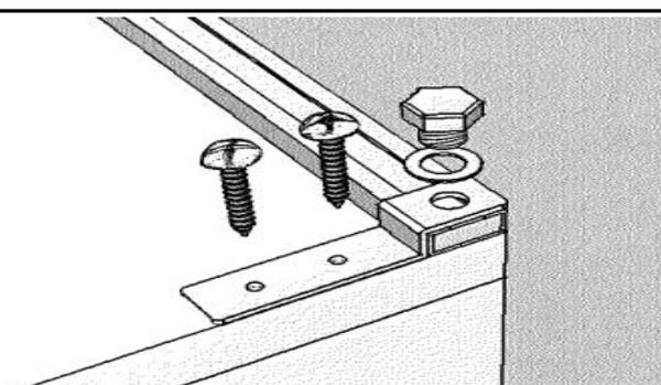
⑥家具の両サイドのどちらかが壁の場合は平金具を使い、家具の上部に20mm鍋ビスで固定し、ボルト、ナットは他と同じ要領で固定します。
