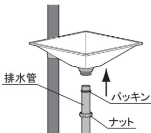
③排水管に防臭ゴムを通し、排水が雨水枡等へ導水できるよう配管して下さい。
