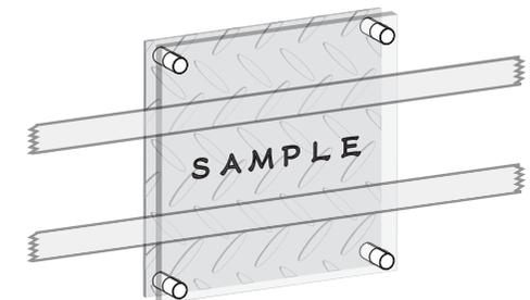
※壁面から表札を浮かせない場合は、裏面のナットを外し、表札を取り付けてください。
