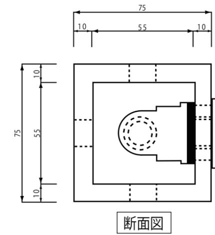
陶製水栓柱水抜きバルブ設置例
