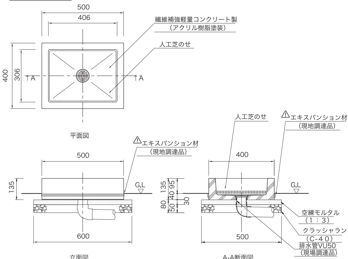
△ 土間コンクリート、モルタルにて製品周囲を拘束する場合、製品にクラックが発生する可能性がありますので製品周囲に必ずエキスパンション材を巻いてください。
