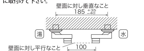
※給水配管が右側、給湯配管が左側に配管されていることを確認して下さい。
