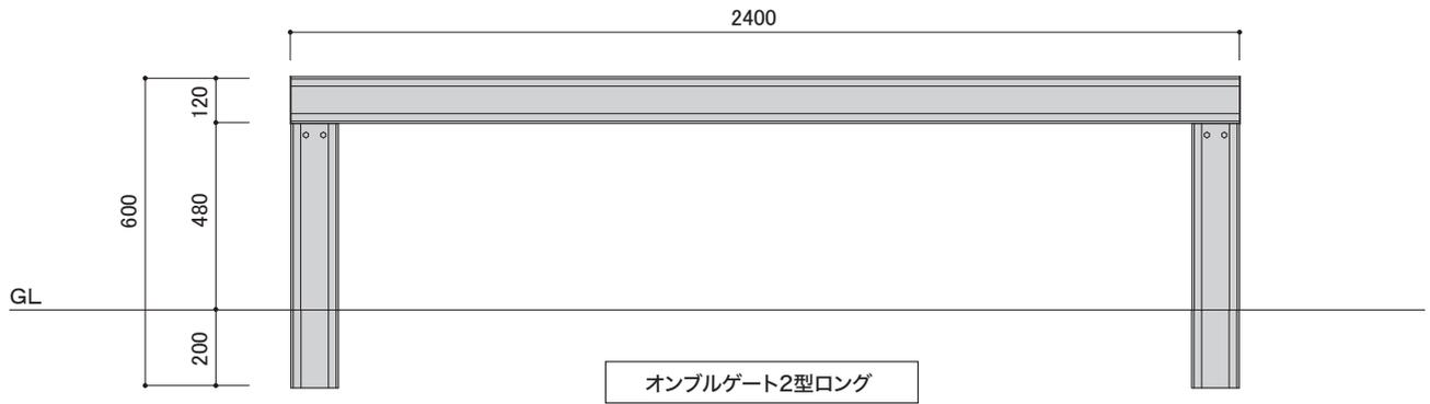
【 オンブルゲート2型ロング コーナータイプ寸法図(上面図) 】
