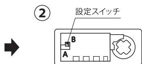
②裏面の設定スイッチをBへ動かしてください。
