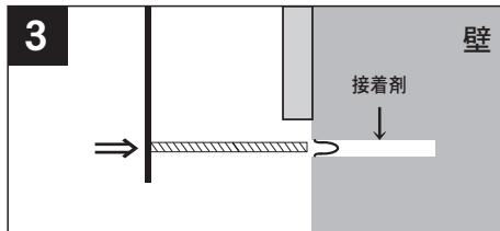
壁面の穴に接着剤を注入し、パートのボルトを差し込みます。パート表面を保護してから養生テープ等で固定し、接着剤が硬化したらテープを剥がします。
