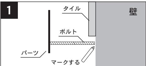
取り付けたい場所にパートをあてがい、ボルト位置をペン等で壁面にマークします。
