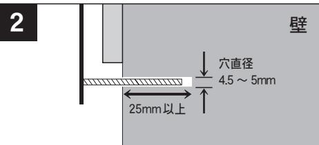
マーク位置にドリルで垂直に穴をあけます。（直径 4.5 ~ 5mm）取付面からパートまでの距離が好みの高さになるよう、パートを差し込み調節しながら穴をあけてください。（穴の深さは最低でも 25 ~ 30mm程度あけるようにしてください。）穴の中のゴミは充分に取り除きます。
