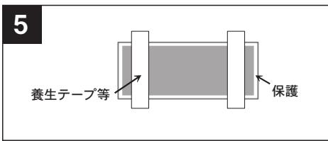
表札の表面を保護してから、養生テープ等で固定します。接着剤が完全に硬化したら、テープを剥がします。
