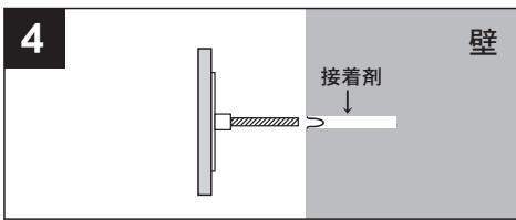
壁面の穴に接着剤を注入し、表札のボルトを差し込みます。
