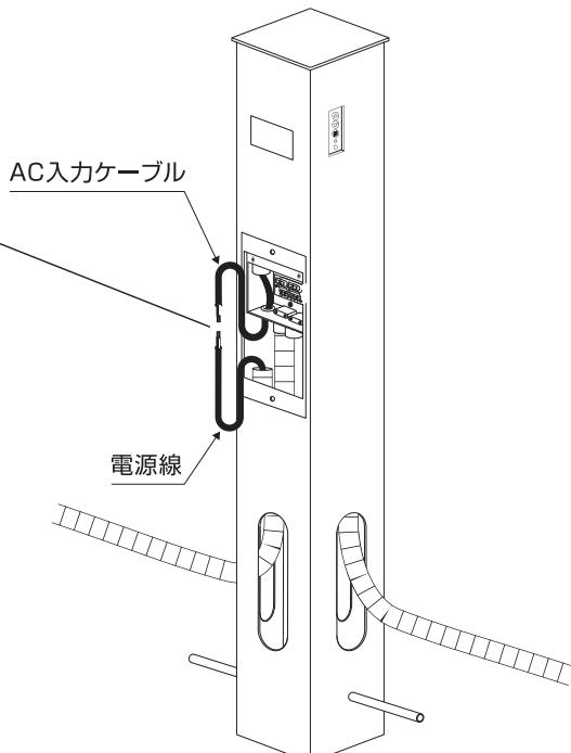
⑤本製品に引き込んだ出力側のケーブルを端子台に接続してください。
