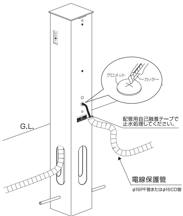
④本製品のAC入力ケーブルと本製品に引き込んだ電源線を防水圧着スリーブなどを用いて結線してください。結線した後、自己融着テープを巻いてください。
