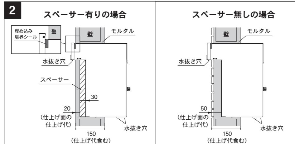
壁面にポスト本体外形寸法より 10～20mm 大きめの穴を開けます。ブロック塀に取り付ける場合は、ブロック積み上げ時にポストを取り付けます。
