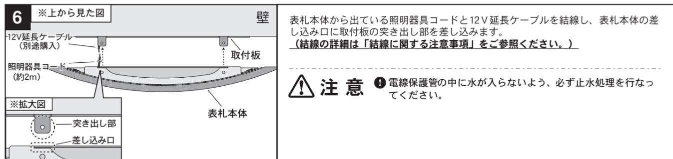
表札本体から出ている照明器具コードと12V延長ケーブルを結線し、表札本体の差し込み口に取付板の突き出し部を差し込みます。
