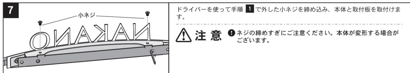
ドライバーを使って手順 ① で外した小ネジを締め込み、本体と取付板を取付けます。
