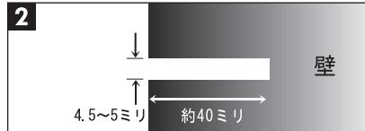
取り付け用紙をはがし、印を付けた位置にドリルで穴を垂直に開けます。(直径4.5~5ミリ、深さ約40ミリ)穴の中のゴミは充分に取り除きます。
