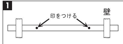
壁面の汚れや付着物を落とし、切り取った取り付け用紙を水平にあてがい、たるまないよう注意しながらテープで貼ります。取り付け穴位置(円の中心)2ヶ所にペン等で、印を付けます。
