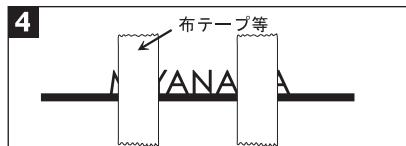
接着剤が完全に硬化するまで、布テープ等で必ず固定して下さい。
