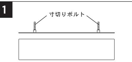
付属の寸切りボルトを表札裏面のネジ穴にねじ込んで取り付けます。ゆるみがないようご注意ください。
