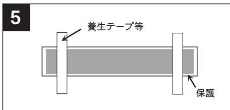
表札の表面を保護してから、養生テープ等で固定します。接着剤が完全に硬化したら、テープを剥がします。
