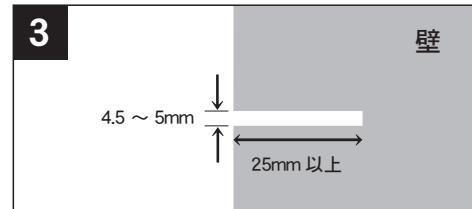
マーク位置にドリルで垂直に穴を開けます。表札を壁から浮かしたい距離になるよう調整しながら穴を開けてください。
