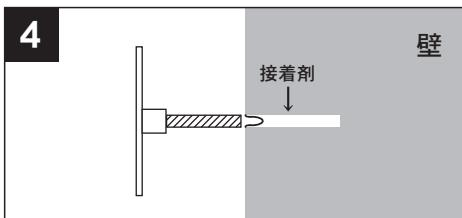
壁面の穴に接着剤を注入し、表札のボルトを差し込みます。
