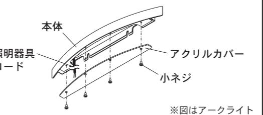
本体に取り付けてあるアクリルカバーの小ネジ4箇所をゆるめ、アクリルカバーを取り外します。(モノライトの場合は、小ネジ2箇所になります。)
