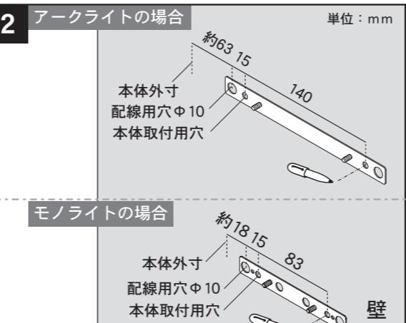
壁面の汚れや付着物を落とします。壁面の取り付けたい位置に取付板を水平にあてがい、本体取付用穴と配線用穴の位置をペン等で印を付けます。(取付板には上下の指定はありません。)
