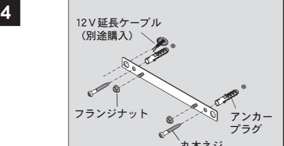
本体取付用穴に付属のアンカープラグを奥まで差し込みます。壁面に取付板をあてがい、取付板の穴と壁面の穴を合わせて丸木ネジでねじ込み、取り付けます。取付板のボルトに付属のフランジナットを仮止めしておきます。
