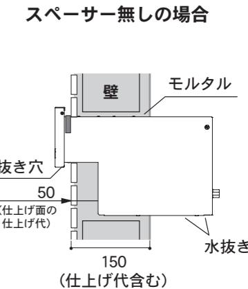
壁面にポスト本体外形寸法(W390×H190)より10~20mm大きめの穴を開けます。ブロック塀に取り付ける場合は、ブロック積み上げ時にポストを取り付けます。
