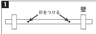
壁面の汚れや付着物を落とし、切り取った取り付け用紙を水平にあてがい、たるまないよう注意しながらテープで貼ります。取り付け穴位置(円の中心)2ヶ所にペン等で、印を付けます。
